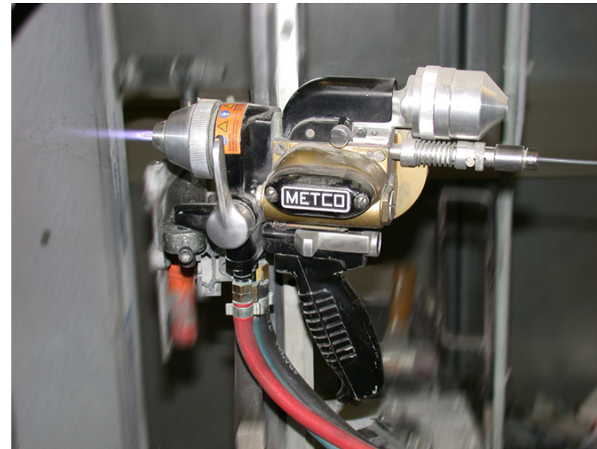
Metalización con pistola de gas (WFS): Material
