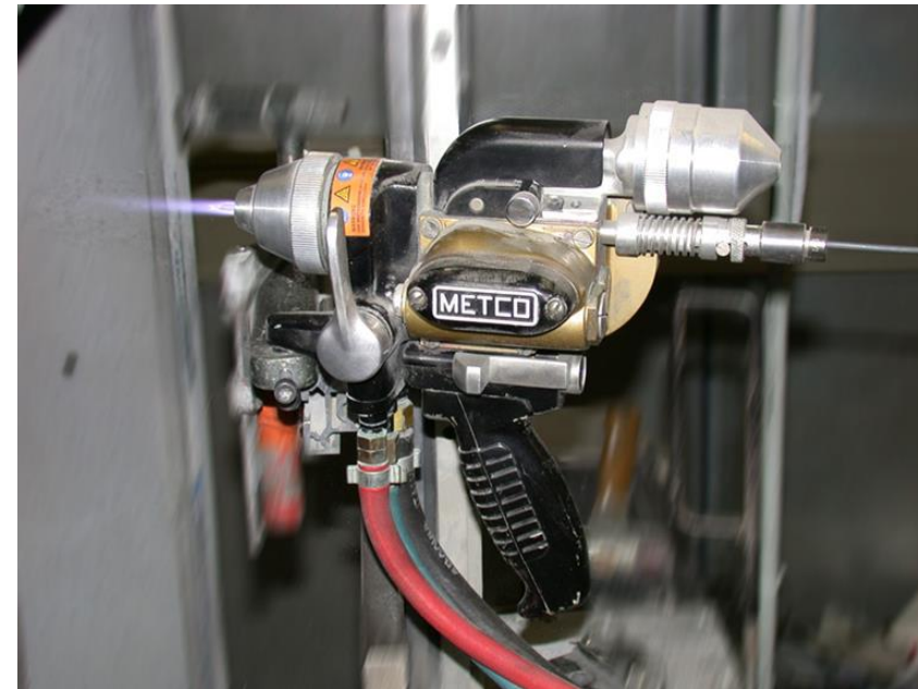
Metallisatie met gaspistool (WFS): Uitrusting
