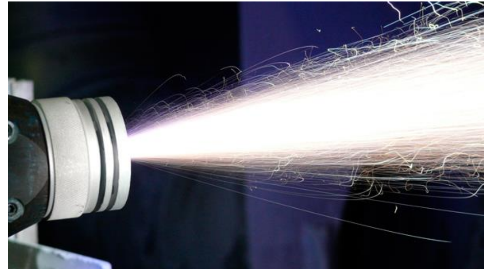
Metallisatie met elektrische vlamboog (AS): Uitrusting
