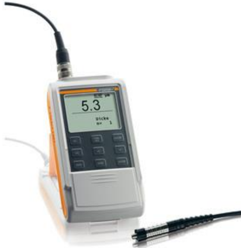
Magnetisch inductie meetapparaat volgens EN ISO 2178
